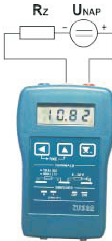
Obr. 2 Zapojení ZUS22 v režimu pasivní generace proudu
